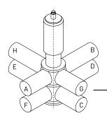
Bei zusätzlichen Stutzen und/oder Abweichungen von der Standardstutzenanordnung, bitte Stutzen mit Buchstaben spezifizieren.
