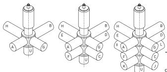
Bei zusätzlichen Stutzen und/oder Abweichungen von der Standardstutzenanordnung, bitte Stutzen mit Buchstaben spezifizieren.
